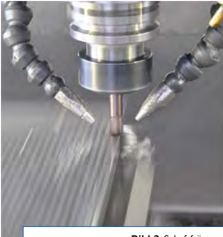
Bild 2: Schaftfräsen mit Quad-Schichten Werkzeuge: VHM-Schaftfräser - d=8 mm - z=4 - a p =5 mm - a e =3.5 mm - v c =110 m/min - f=0.24 mm/U Werkstückmaterial: DIN 1.2085 - X33CrS16 - 31 HRC - externe Minimalschmierung.
