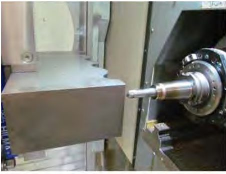
Bild 6: Hartfräsen mit Quad-Schichten Werkstück: Wellenprofil - Material: X155CrVMo12 - 1.2379 - gehärtet auf 55 HRC Kühlung: IK-Luft Werkzeug: WPR 16-SF - v_c=240 m/min - f_z=0.2 mm - v_f=1910 mm/min - a_p=0.2 mm - a_e=0.3 mm Getestet von LMT-Kieninger, Lahr, Deutschland.
