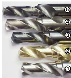
Werkzeug: Stufenbohrer aus Aluminium; GIW/PCG Werkstückmaterial: GD-AISI9Cu3(Fe); 9,3% Si Quelle: PLATIT AG und PannonPLATIT, Budapest, HU
