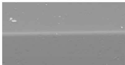
Stempel beschichtet und nassgestrahlt
