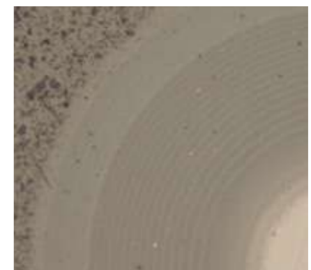
Calo 3-lagig CrN Heftschicht → AlTiCrN Kernschicht → AlCrSiN Topschicht
